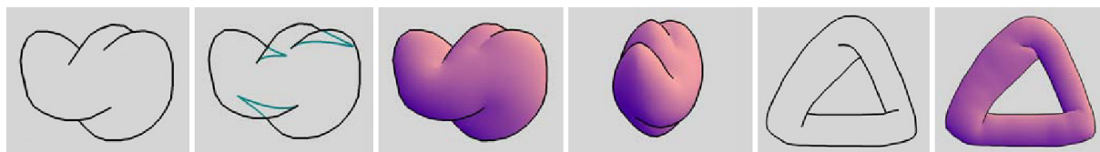
Figura 23. Criação de modelo 3D usando esboço do utilizador e contornos escondidos assumidos pelo sistema (Karpenko & Hughes, 2006).
